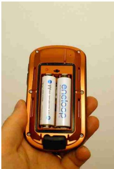
Una volta ricaricate con un caricatore generico per pile stilo AA, reintrodurle nel GPS facendo attenzione alla polarità e riapplicare il coperchio ruotando nuovamente la chiavetta.
