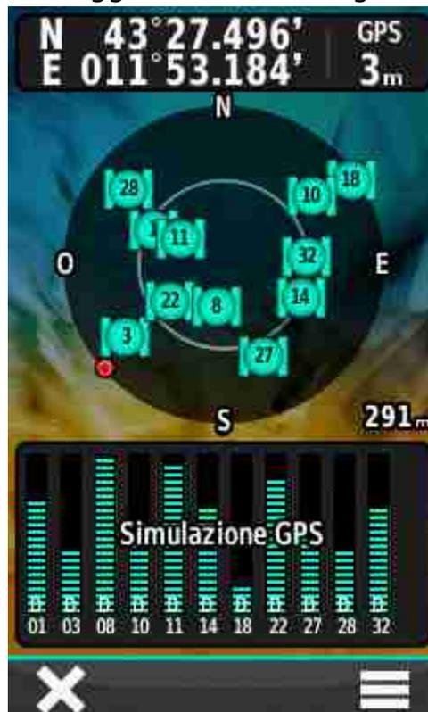
È in particolare da verificare il valore in alto a destra che riporta la precisione corrente. Un valore di 3 m è corretto. Se fosse superiore attendere il completamento del FIX dei satelliti e il miglioramento della precisione prima di procedere.
