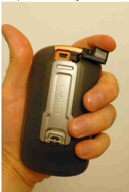
al GPS e al computer. Accendere il GPS. Il dispositivo sarà visibile in Esplora Risorse del computer come una pennina USB.
